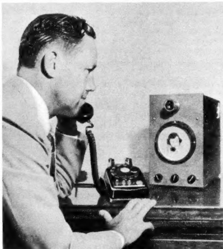
Bild 3. Versuchsausführung des Bell-Picturephone. Neben dem Fernsichtapparat ist das Labormuster des in Bild 2 (rechte Seite) dargestellten Sichtgerätes einschließlich Kleinkamera und Trommel-speicher zu erkennen
